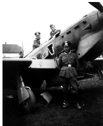
Zarobljeni IK-3 br.13/2162 na Zemunskom aerodromu, aprila 1941. godine ispred kojeg pozira nemački oficir. Uklonjena oplata u korenu krila otkriva da je demontiran krilni spremnik goriva. Photo-Đorđe Nikolić collection via Nenad Miklušev
