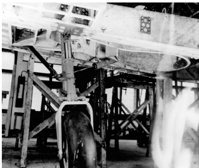
Rogožarski IK-3, detalji noge stajnog trapa tipa Messier i strukture krila. Photo-Yugoslav Aviation Museum via Nenad Miklušev
